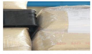
高低平板车装货仅适用枕木,但未使用防护纸板导致托盘和产品 包装直接接触易破包 Only sleepers are used for loading high and low flatbed trucks,but
